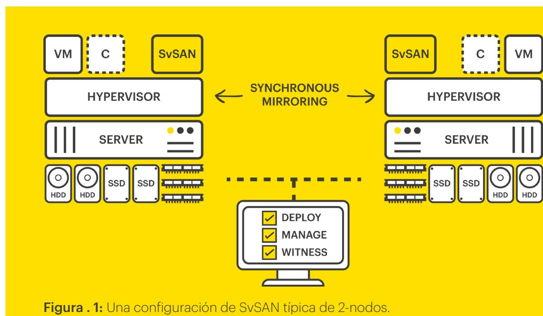
Figura . 1: Una configuración de SvSAN típica de 2-nodos.
